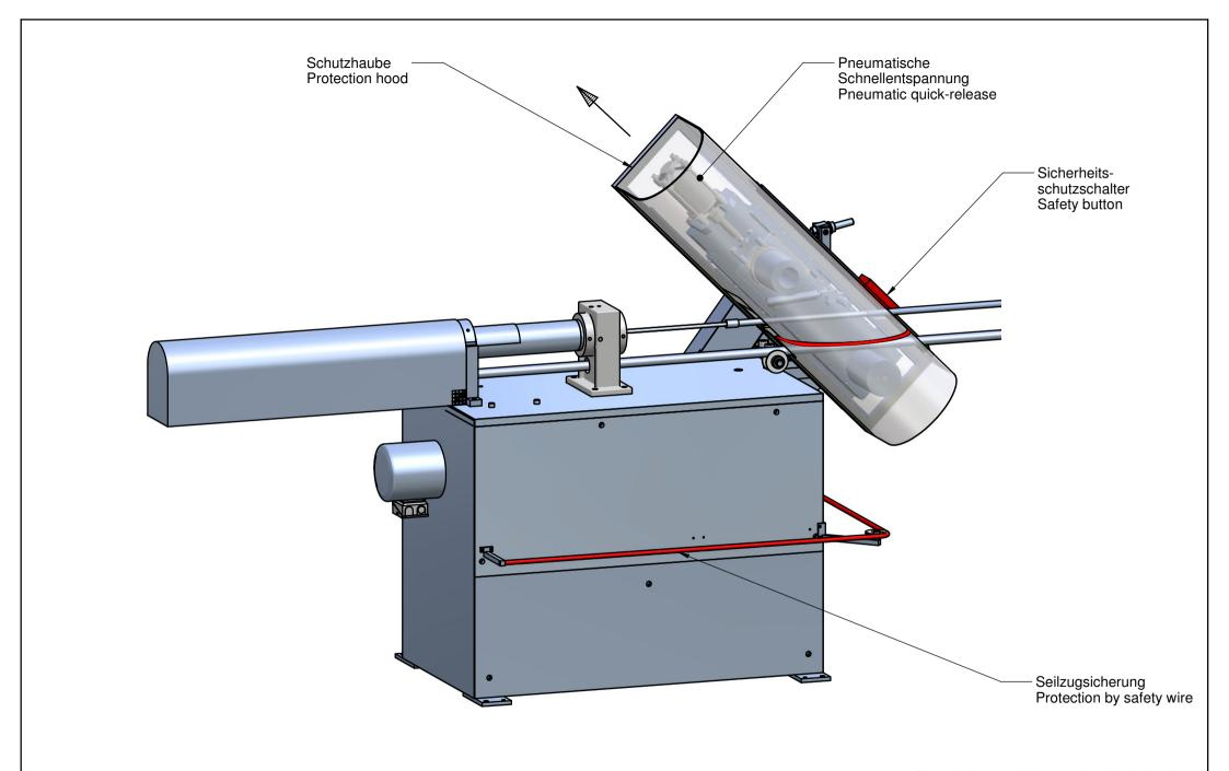
Sicherheitsempfehlungen für Wickelköpfe von Spiralwickelmaschinen Safety recommendations for winding heads on spiral winding machines
